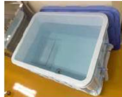
図3. 水槽を塩素消毒するための大型容器 (次亜塩素酸ナトリウム0.02%, 2時間以上浸漬)
